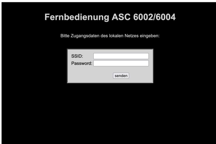
SSID und Password des Heimnetzes können nun eingetragen werden. Mit ‚senden‘ werden die Daten im D1 hinterlegt und die Fernbedienung neu gestartet.
