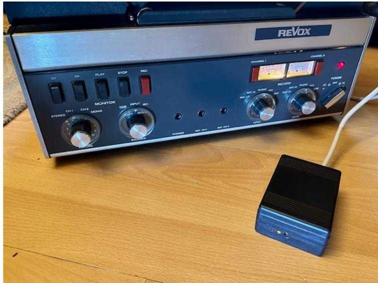
Ziel war es, eine Fernbedienung zu entwickeln, bei der das Tonbandgerät sowohl per Infrarot, als auch über WLAN ansteuerbar ist. Als zentrales Steuerelement wurde ein WEMOS D1 mini Mikroprozessor gewählt. Er übernimmt die Decodierung der IR-Fernsteuerimpulse und die Ansteuerung der A77 mittels Transistoren sowie die Kommunikation über das WLAN. Die 3,3V Versorgungsspannung für den D1 wird mit einem Step-Down-Wandler aus den 27V der A77 erzeugt.
